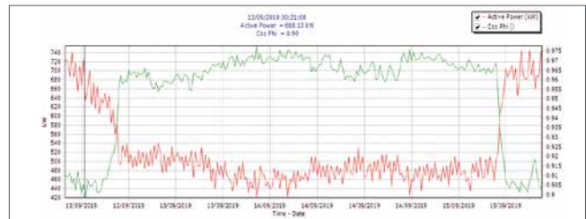
▲ Fig. 3: Informe de contadores de los principales medidores de la planta. El consumo eléctrico (potencia activa) y el correspondiente factor de potencia (coseno phi) son obtenidos cada 15 minutos. En los fines de semana pocas máquinas están en producción y por lo tanto la potencia activa disminuye y el factor de potencia mejora. Los gráficos muestran que el factor de potencia permanece sobre 0,9, que indica que es una situación aceptable. Este gráfico permite también valorar el funcionamiento de la batería de condensadores que mejoran el factor de potencia.
